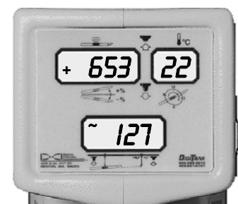
Режим позиционирования с отображением уровня сигнала, температуры излучателя и прогнозируемой глубины
